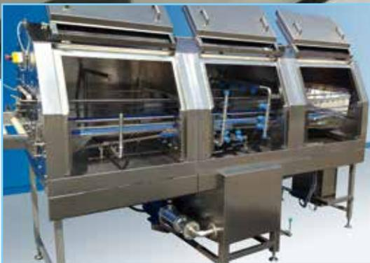
Durch den Aufbau aus Einzelmodulen kann die Anlage an die räumlichen Gegebenheiten angepasst werden. So ist auch bei beengten Platzverhältnissen eine automatisierte Be- und Entstapelung möglich.
